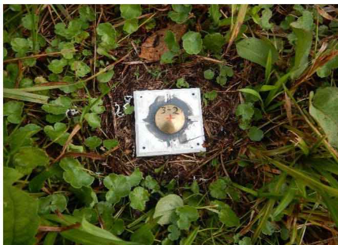
3級基準点（合成杭+金属標）
