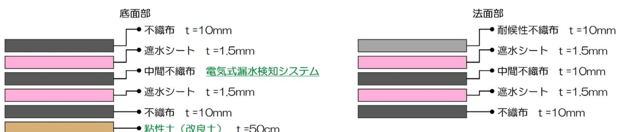
図 3.9 遮水工の構造（標準断面）
