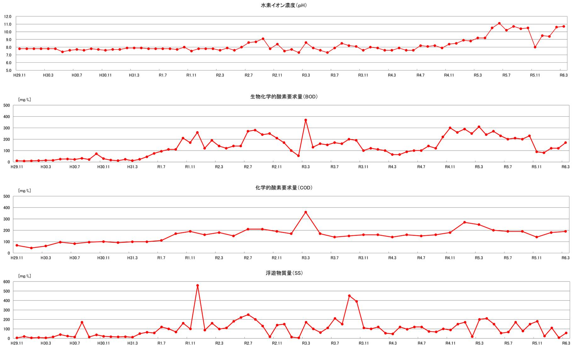
図 3.22 浸出水原水水質の経時変化 (1/2)
