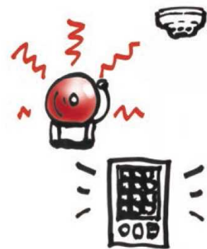
自動火災報知設備
